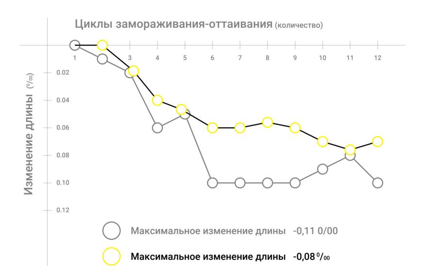
Изменение длины образца материала при испытании на морозостойкость после цикла замораживания-оттаивания не превышает 0,1% (0,01%). Согласно немецкому стандарту, в бетоне допускается изменение до 1 промилле. StabilRoad на 100% эффективнее!
