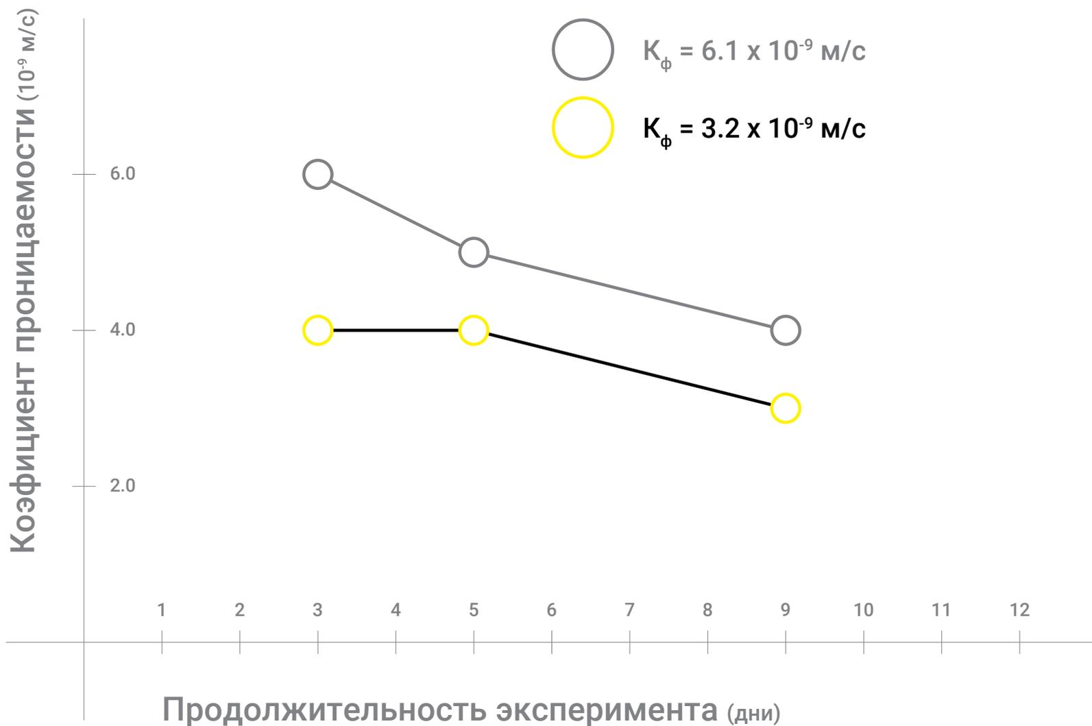
Водопроницаемость составляет от  $10^{-8}$  до  $10^{-9}$  м/с, что означает, что материал практически не пропускает воду.  $3,2 \times 10^{-9}$  м/с = 0,28 мм/сутки. Водопроницаемыми считаются материалы с фильтрацией от менее 0,5 м/сутки. Водонепроницаемыми считаются материалы с фильтрацией до 100 мм за 72 часа – это считается достаточным значением. 1 мм StabilRoad на 100% эффективнее!
